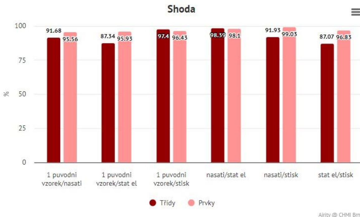
Obrázek 15: srovnání 3 metod přenosu částic. Je patrné, že nejvyšší shody s původním vzorkem dosahuje metoda stisku.
